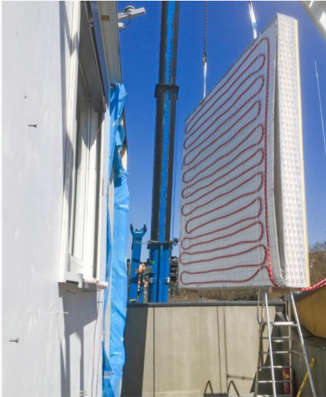
Einbau des Fassadenprototyps aus „MultiTab“ in die Fassadenprüfanrichtung bei AEE Ittec Foto: AEE Ittec
