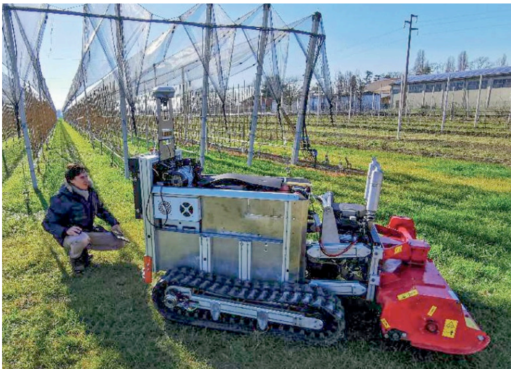
Rover a guida autonoma elettrica in prova presso il Centro Sperimentale di Cadriano
